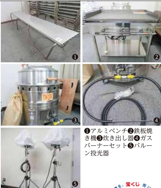
①アルミベンチ ②鉄板焼き機 ③炊き出し器 ④ガスバーナーセット ⑤パルン投光器
