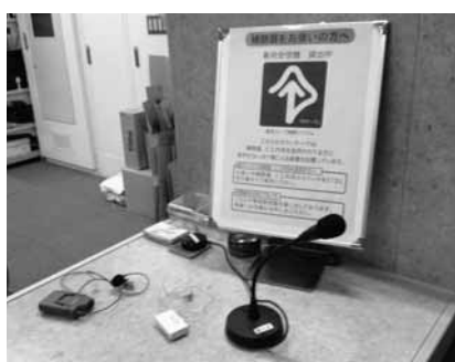
窓口の磁気ループ
